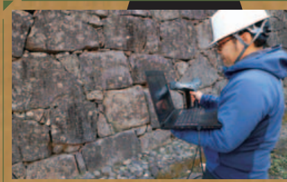
3Dスキャニングレーザーを用いた熊本城内石垣の3D計測調査。計測したデータは熊本市と共有しています。
