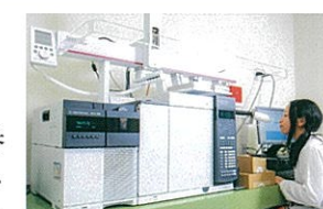
自身が嗅いだ香りの検出、特定ができる【GC-MS:匂いかぎシステム】
