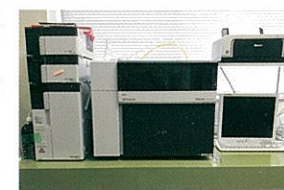
プロテインシーケンサー 酵素(タンパク質)の解析をします。
