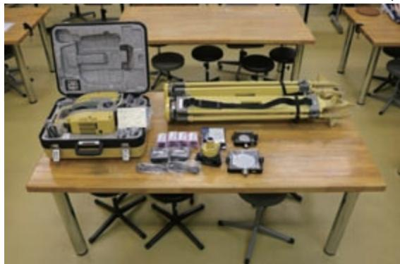
導入設備 3次元レーザースキャナー (GLS-2000)
