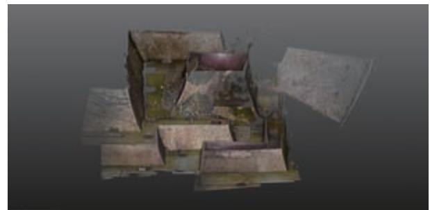
写真5 I期調査(熊本城内)の石垣計測 3D データから植生等を除去した 3D 点群データ (GLS-2000)
