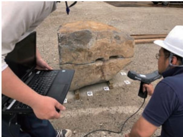
写真2 現地矢穴測量調査風景 (FARO)
