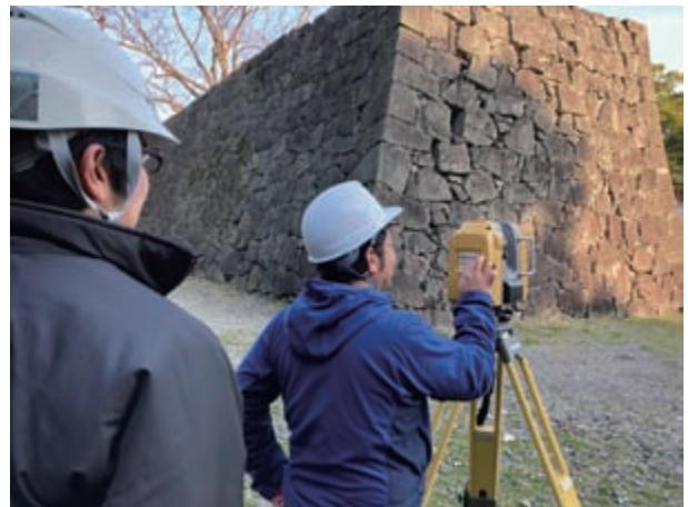
写真1 現地石垣測量調査風景 (GLS-2000)
