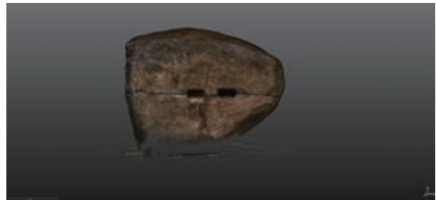
写真3 矢穴部分の計測 3D データ (FARO)
