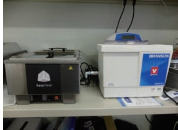
導入設備 クリーナー (左)・超音波洗浄器 (右)
