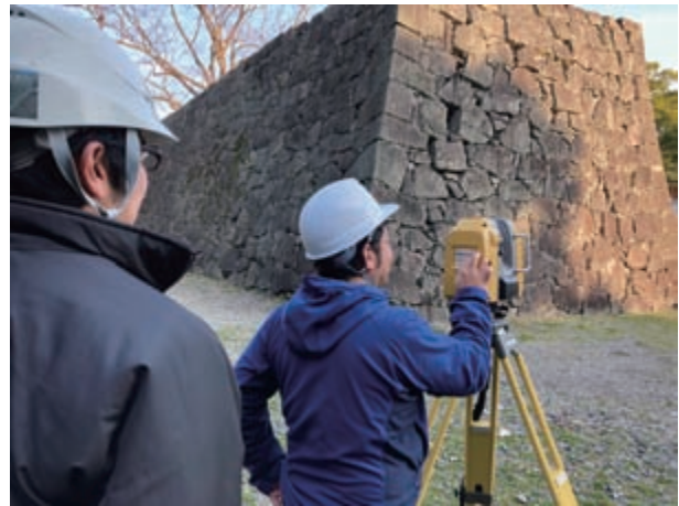
写真1 現地石垣測量調査風景 (GLS-2000)
